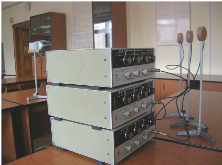
Рисунок 2 — Внешний вид установки (1 — телефоны, 2 — шумомер)
