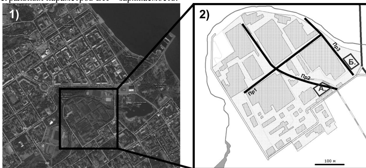
Рис.1. Космоснимок г. Петрозаводска (1) и схема (2) исследуемого участка с нанесёнными профилями, где: А. мазутохранилище; Б. нефтеловушка
