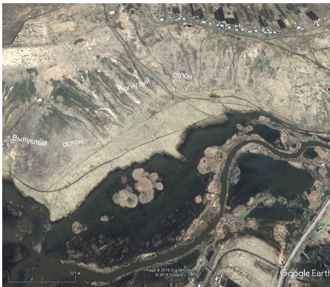
Рис. 1. Овраги образуются на вогнутом отрезке берегового склона и отсутствуют на выпуклом
