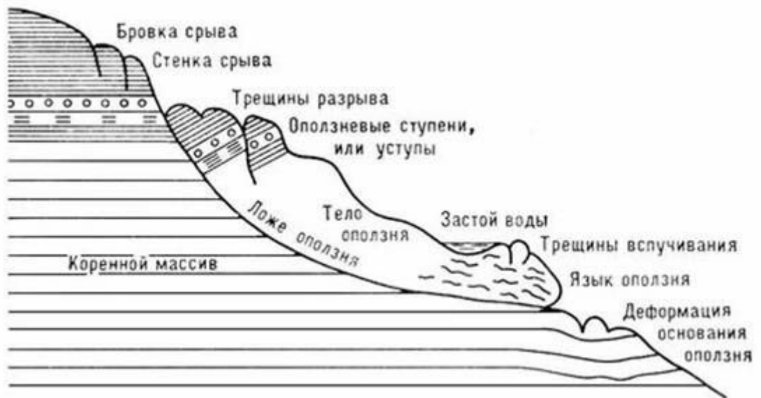
Рис.1 . Продольный разрез оползневого склона
