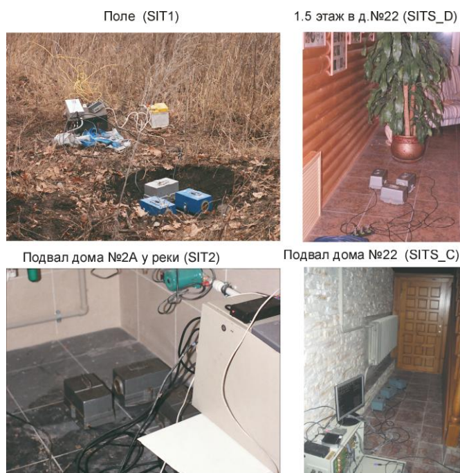
Рис.3 Размещение оборудования на пунктах наблюдений при регистрации взрыва
