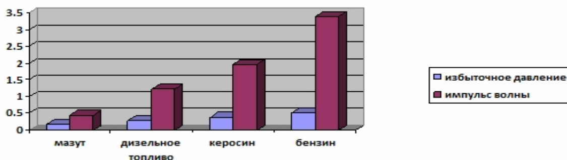
Рисунок 2. Диаграмма соотношения жидких топлив при одинаковой их массе 10 т и одинаковом расстоянии до хранилища ( r = 750 м).
