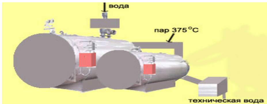
Рисунок 3. Пиролизная установка для перегонки воды. Получение технической воды
