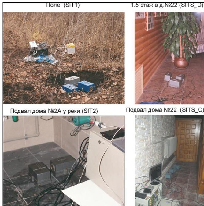
Рис. 3 Размещение оборудования на пунктах наблюдений при регистрации взрыва № 68
