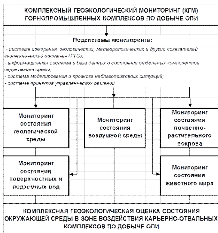
Рис. 1. Структурная схема комплексного геоэкологического мониторинга (КГМ) горнопромышленных комплексов по добыче ОПИ
