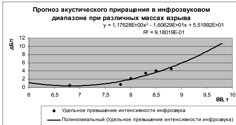
Рис.2. Прогноз акустического приращения в инфрозвуковом диапазоне при различных массах взрыва
