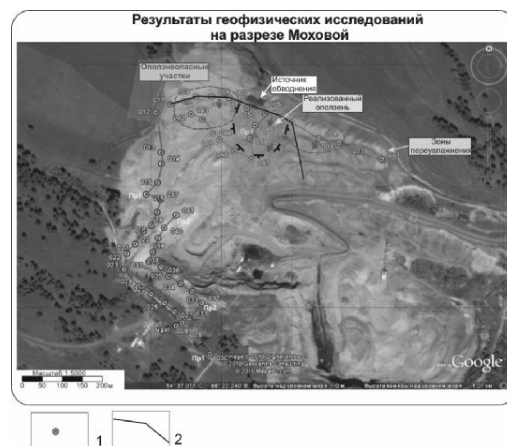
Рисунок 4 Расположение оползнеопасных блоков на разрезе Моховой 1 – пункты ЗСБ; 2 – профили электромагнитного сканирования
