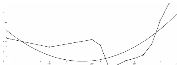
Рисунок 2 – Процентный годовой прирост выбросов метана при очистке сточных вод жилищно-коммунального хозяйства в России относительно 1990 г.: уравнение тренда y=4,72-1,69 \cdot x+0,15 \cdot x^2
