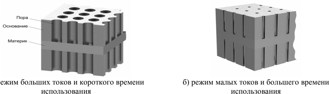
Рисунок 1. Морфология структуры электрода водородного аккумулятора для разных режимов работы.
