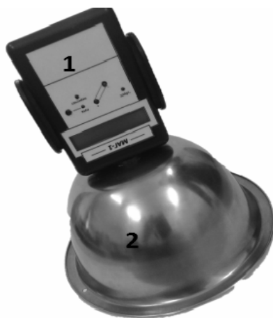
Рисунок 1 – Анализатор газов с открытым входом для детектирования нефтепродуктов в воде и грунте 1 – корпус анализатора; 2 – съемная ячейка детектирования
