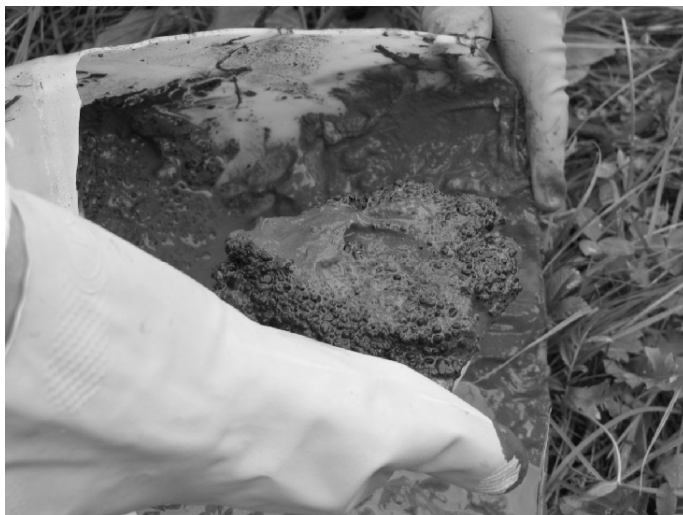
Рисунок 2 Образование желваков лимонита в районе сброса сточных вод после установки обезжелезивания водоподъемной станции № 8 (ВПС-8)
