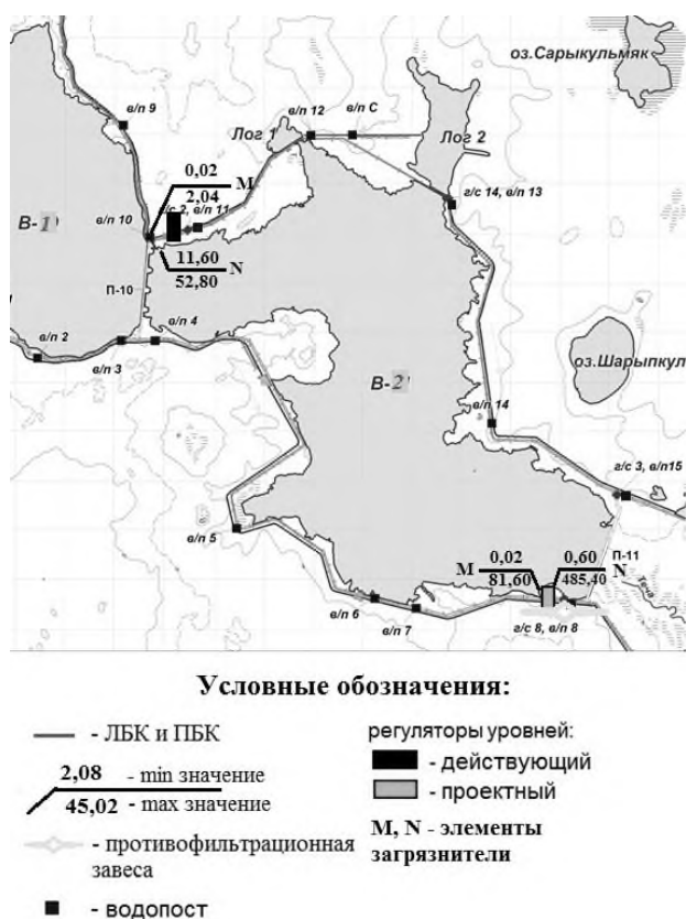
Рис. 1 Проектные и действующие пороги-регуляторы
