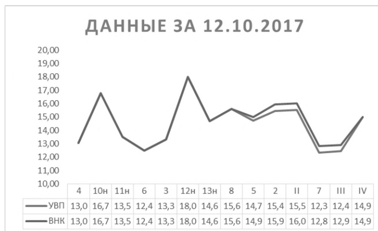
Рис. 3 . График уровней залегания подземных вод и линзы нефтепродуктов ( октябрь 2017)
