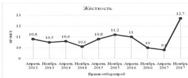
Рис. 2 График динамики жесткости в водах альб-сенаманского водоносного комплекса
