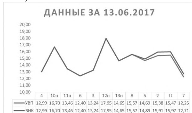
Рис. 2 . График уровней залегания подземных вод и линзы нефтепродуктов ( июнь 2017)
