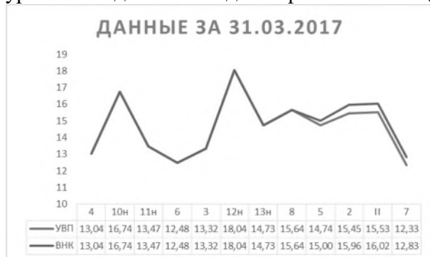
Рис. 1 . График уровней залегания подземных вод и линзы нефтепродуктов( март 2017)
