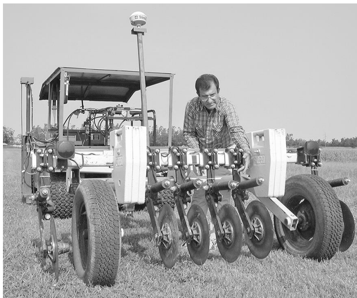
Рис. 3. Прицепная геофизическая станция (США) для изучения влажности почвы.
