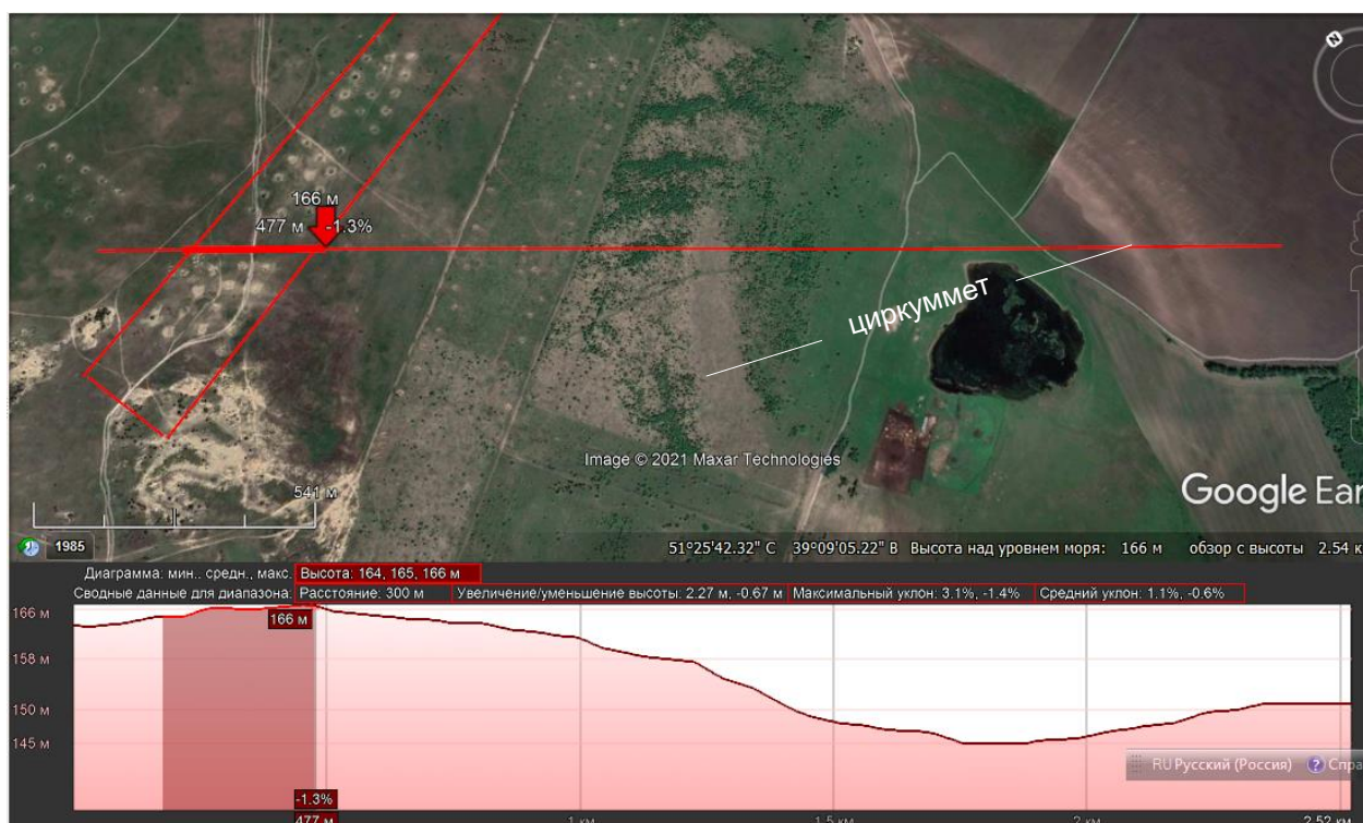
Рисунок 1 – Поверхностный сток с участка с взрывными воронками может быть направлен к циркуммету, от которого начинается водоток Карпичихино Лога на север в сторону водохранилища.
