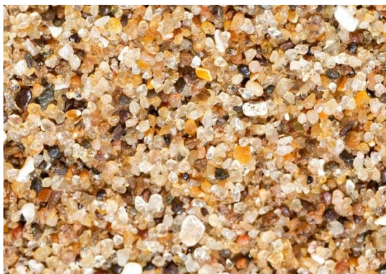
Рисунок 1 – Состав песчаного грунта под микроскопом
