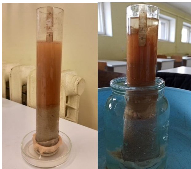
Рисунок 2 – Кольтматация песчаного грунта с водой и с нефтепродуктом
