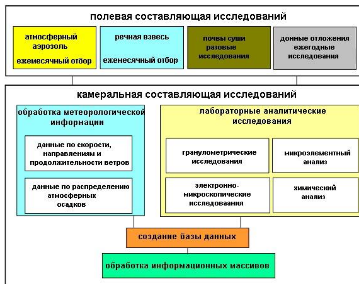
Рисунок 1 - Обобщенная схема реализации задач экологического мониторинга (в блочной форме представлены задействованные виды полевых наблюдений и лабораторных исследований)
