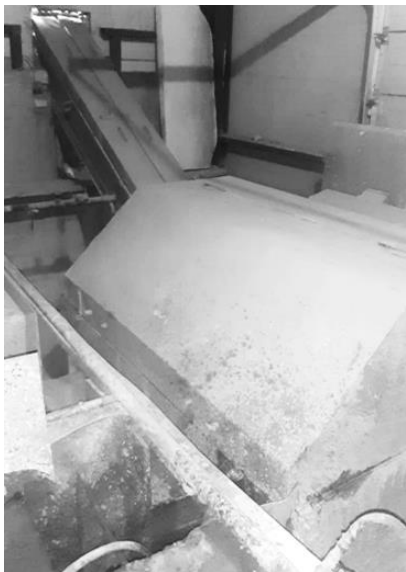
Рис. 2 Шнековый механизм (служащий для подачи инертных материалов)
