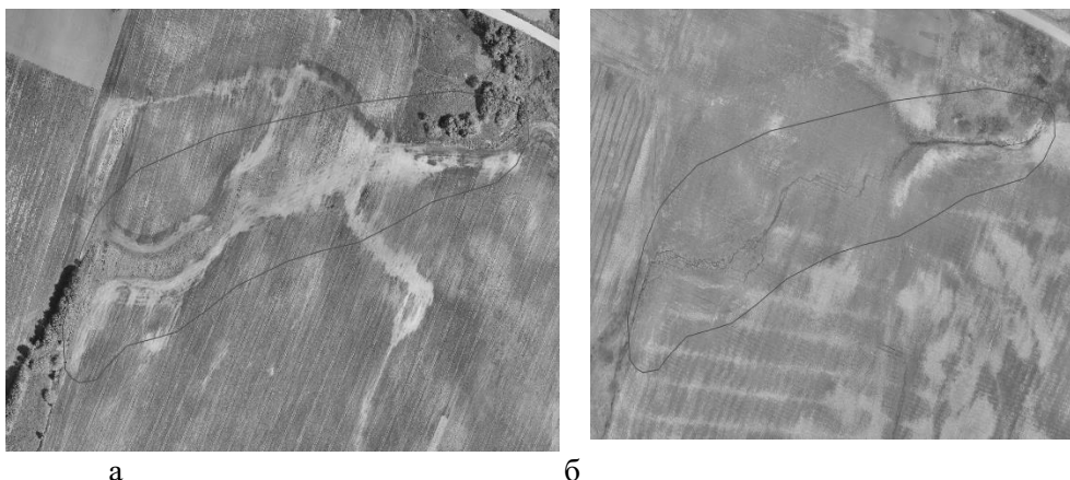
Рис. 2. Развитие эрозии на месте интенсивного движения сельхозтехники: август — сентябрь 2022 г. - а, весна 2023 г. - б .
