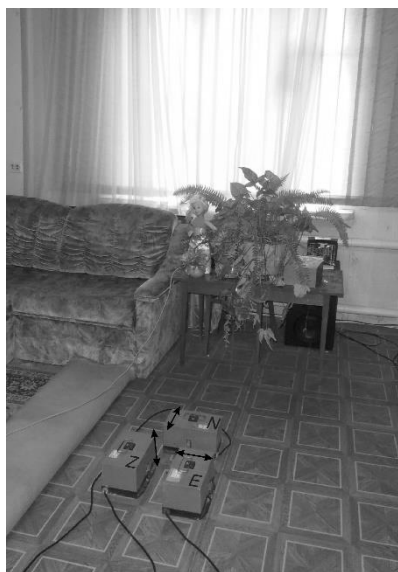
Рис. 2. Ориентация сейсмоприемников в месте установки
