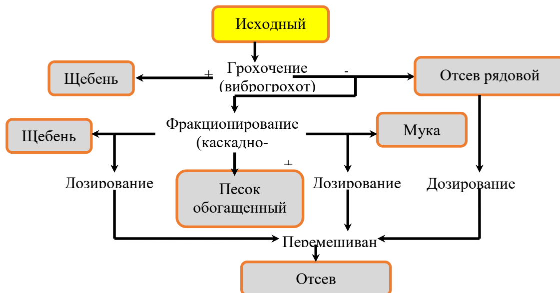
Рис. 1. Принципиальная схема вариативной подготовки отсевов камнедробления к их строительно-технологической утилизации
