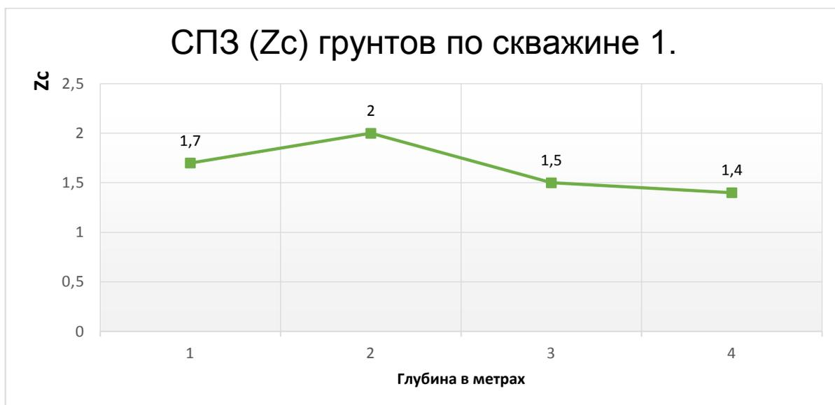
График 2– Суммарный показатель загрязнения (Zc) грунтов в зависимости от глубины по скважине 1 (№ проб 36, 39, 42, 45).
