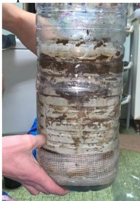
Рис. 5. Система каналов и трещин в глиняном слое
