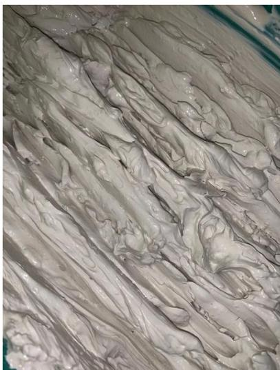
Рис. 1. Каолинитовая глина, используемая в опыте
