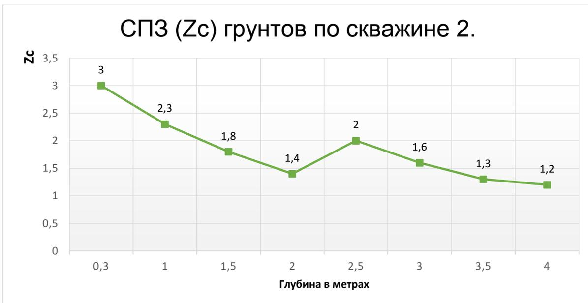
График 3– Суммарный показатель загрязнения ( $Z_c$ ) грунтов в зависимости от глубины по скважине 2 (№ проб 37, 38, 40, 41, 43, 44, 46, 47).
