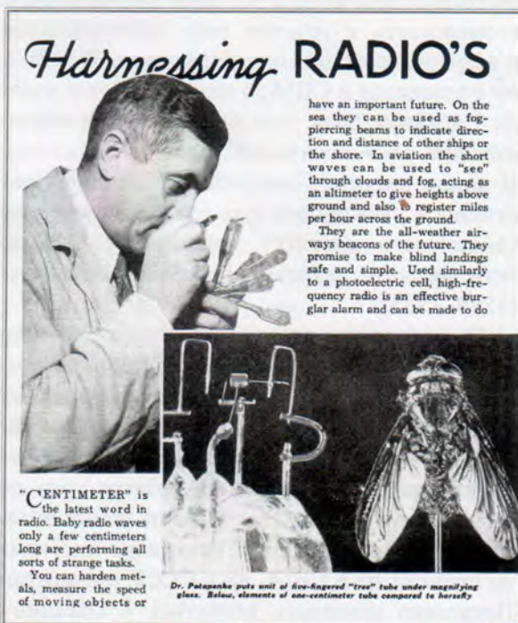
Фрагмент статьи 1937 года из Popular Mechanics Magazine [14]. Г.В. Потапенко рассматривает электронные лампы для генерации сантиметровых радиоволн, а ниже элементы этих ламп сопоставляются с размерами слепня
