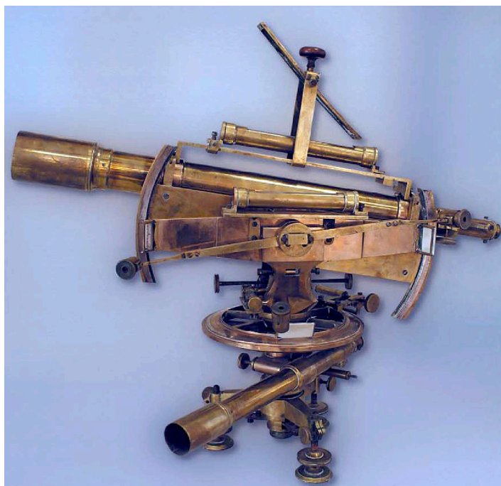
Нивелир-теодолит Г.К. Брауэра из собрания Нижегородского музея геодезических инструментов
