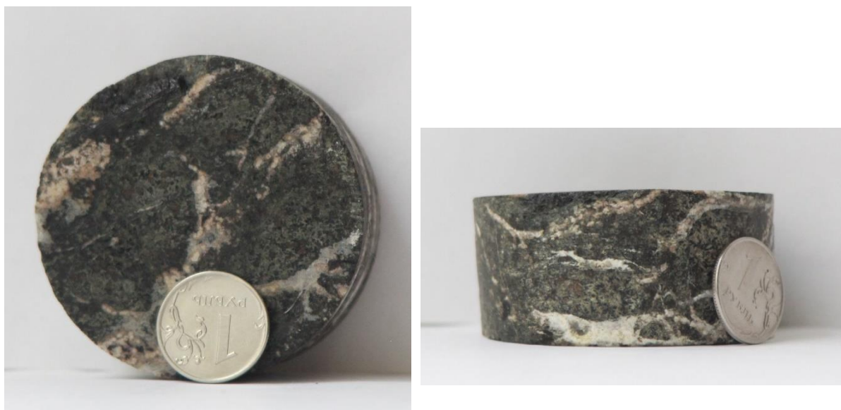
Рис. 2. Вторичные изменения по габбродолеритам новогольского комплекса: изменённый темно-серый габбродолерит с развитыми по трещинам кальцитом и кварцем (обр. К-48/501,6)
