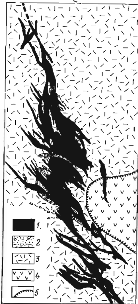
Рис. 390. Схема строения оловянного месторождения Комсомольского района с развитыми трещинами оперения. По В. Кушеву.
