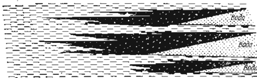
Рис. 19. Линзовидные залежи нефти или газа в пластах выклинивающихся песков среди сланцев. По И. Броду. Условные обозначения см. на рис. 17
