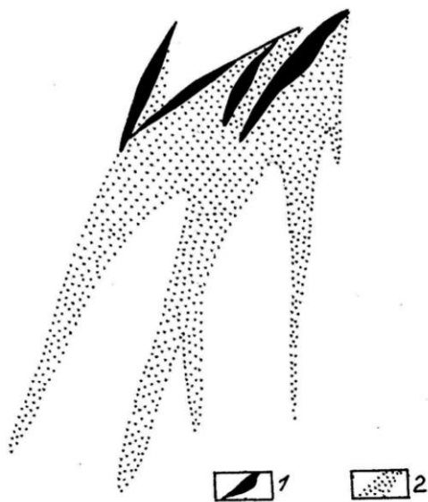
Рис. 3.57. Струйчатая конфигурация делювиальной россыпи (по В. И. Смирнову):
